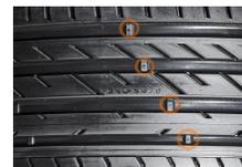
DIE PROFILTIEFE IST MASSGEBLICH FÜR DIE STABILITÄT DES FAHRZEUGES VERANTWORTLICH. DIE RILLEN IM PROFIL SORGEN DAFÜR, DASS DAS WASSER ZUR SEITE ABGELEITET WIRD. DAS VERHINDERT DAS AQUAPLANING (DER REIFEN SCHWIMMT AUF EINEM WASSERKEIL AUF). MINDESTPROFILTIEFE IST MIT 1,6MM VOM GESETZGEBER VORGESCHRIEBEN. DIESE IST ANHAND DER INDIKATOREN (TWI) ZU ERKENNEN.
