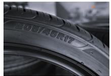
DIE REIFENGRÖSSE IST AN DER REIFENFLANKE ANGEBRACHT DAMIT DU DIESE ZAHLENKOMBINATION VERSTEHST, HIER DIE AUFSCHLÜSSELUNG: 205: REIFENBREITE IN MM 45: FLANKENHÖHE PROZENTUAL ZUR BREITE R: RADIALREIFEN (BAUART) 17: INNENDURCHMESSER REIFEN / FELGENGRÖSSE
