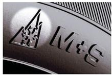
GROB EINZUTEILEN SIND DIE REIFEN IN SOMMER- UND WINTERREIFEN. DIES ERKENNST DU ANHAND DER SYMBOLE (SCHNEEFLOCKE) AUF DEN REIFEN. EINEN SOMMERREIFEN ERKENNST DU DARAN DAS KEIN SYMBOL AUFGEDRUCKT IST.
